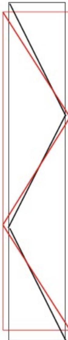
**2- Rétractation des matériaux :** Le Dyneema raccourcis de 0,5 à 1% en vieillissant. Cela fait 7 cm sur la hauteur totale d'un suspentage ! L'Aramide est stable.
